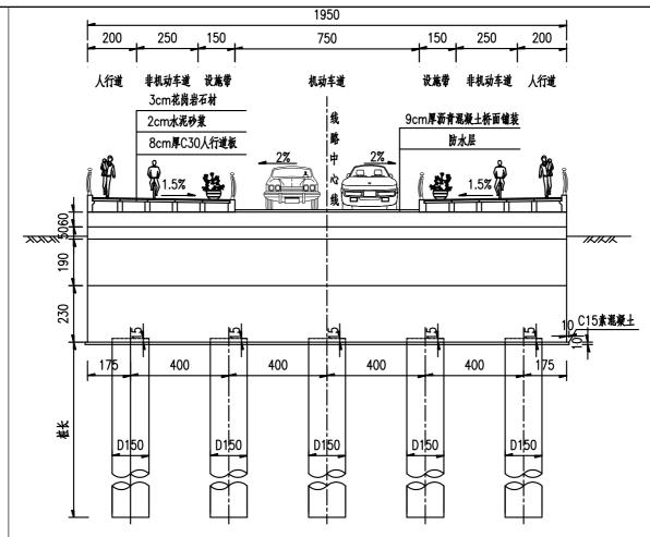
图 2.15 桥台断面图 (单位: cm)
