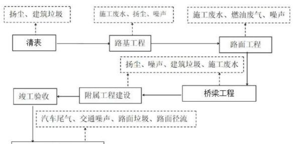
桥梁工程的主要施工工艺流程如下:
