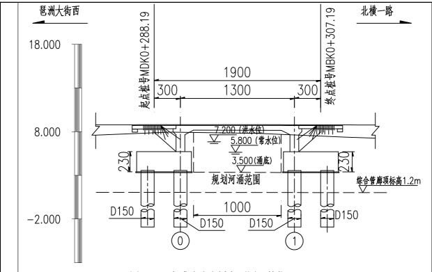
图 2.16 磨碟沙路小桥立面图 (单位: cm)
