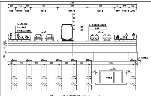
图 2.27 桥台断面图 (单位: cm)
