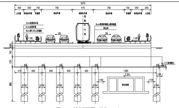
图 2.18 桥台断面图 (单位: cm)
