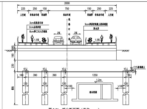
图 2.21 桥台断面图 (单位: cm)
