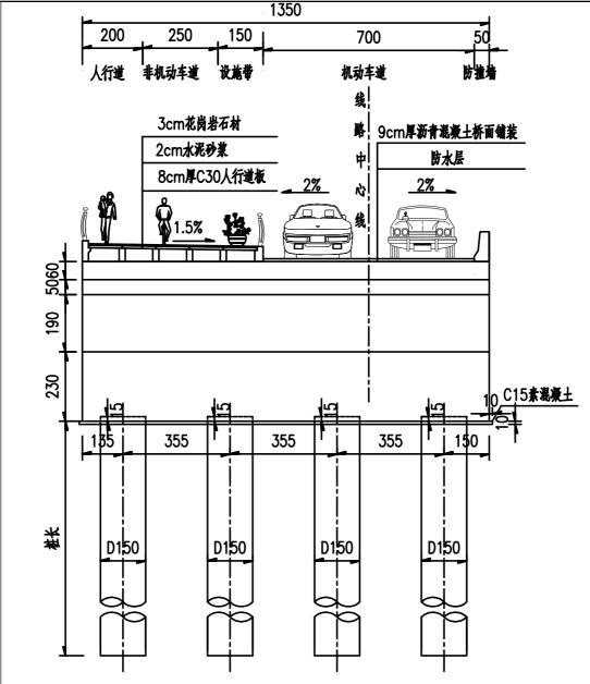
图 2.24 桥台断面图 (单位: cm)
