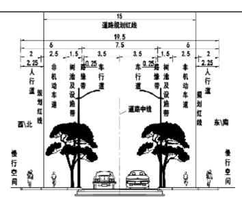
图 2.7 北横三路、北横五路、北横六路、北纵一路、北纵二路、北纵七路道路标准横断面图 f、北纵三路
