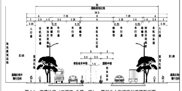
图 2.3 磨碟沙路(双塔路~北横一路)、琶洲北大街道路标准横断面图
