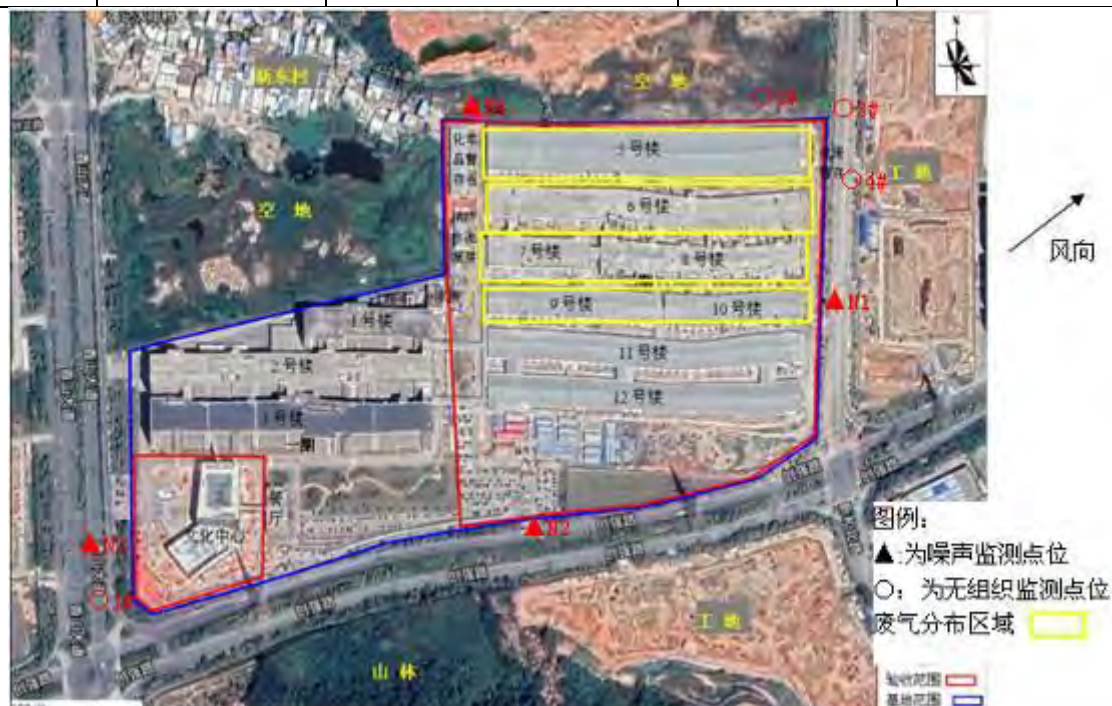
图6-1 项目验收监测点位布设示意图
